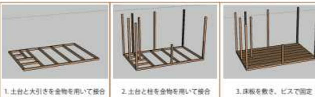
1. 土台と大引きを金物を用いて接合
