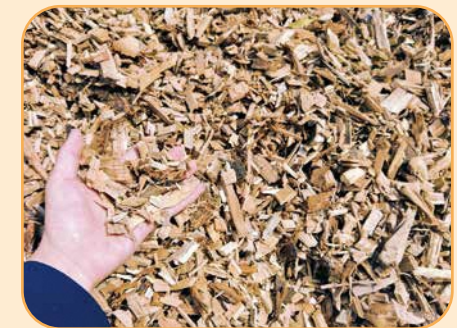
発電材料となる木を細かくくんで乾燥させたチップ
