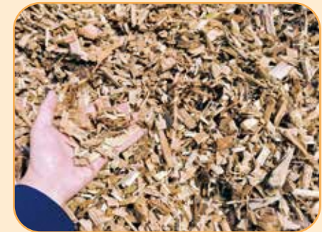
発電材料となる木を細かくくわいて乾燥させたチップ
