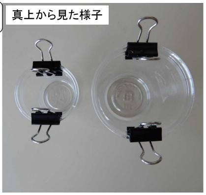
2種類のプラスチックコップを用意し、真上から見たとき およそ一直線上になるよう、同じ大きさのダブルクリップ を取り付ける。
