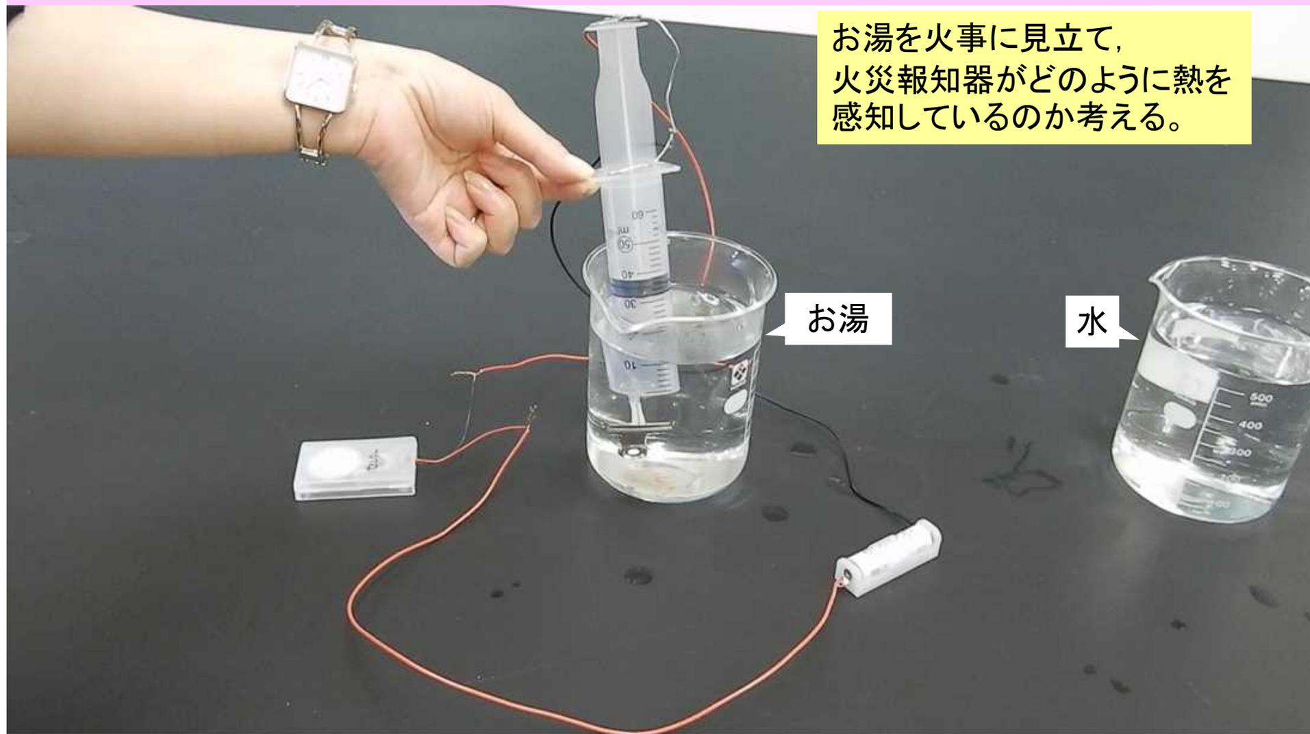
注射器をお湯に入れると、注射器内の空気の体積が大きくなり、ピストンを押し上げる。ピストンに貼り付けたアルミニウムはくが針金と接触すると回路ができて、電子オルゴールが鳴る。
