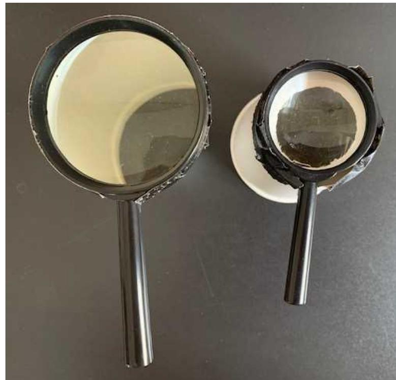
② 紙コップの底を切り抜き筒状にする。一方の凸レンズを紙コップの上面に，もう一方の凸レンズを別の紙コップの底面に取り付ける。
