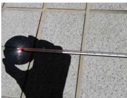
大きな虫眼鏡で集めた小さな光 34^{\circ}\text{C} \rightarrow 60^{\circ}\text{C}
