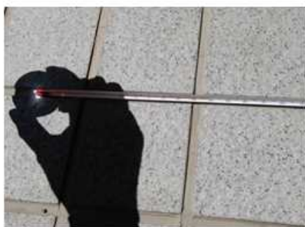
小さな虫眼鏡で集めた小さな光 31^{\circ}\text{C} \rightarrow 46^{\circ}\text{C}
