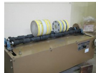
原料の混合 (ボールミル)
