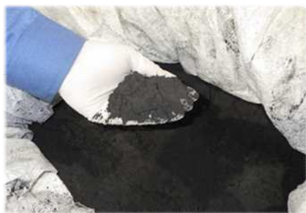
生産された炭化物 (土壌改良補助材料等に利用)
