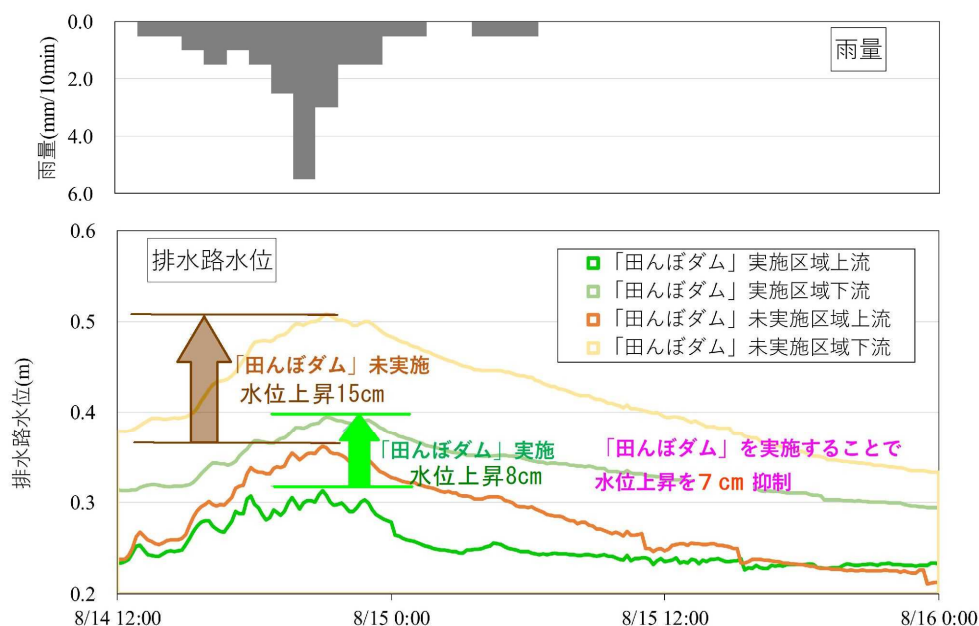
【 図表 2-5：排水路への流出低減による排水路の水位上昇抑制効果 】
