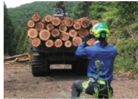
〔 木材検収システム (丸太の本数や太さをAIで自動判別) 〕
