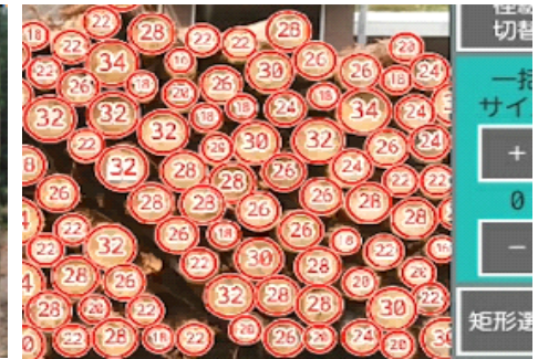
〔 木材検収システム (丸太の本数や太さをAIで自動判別) 〕
