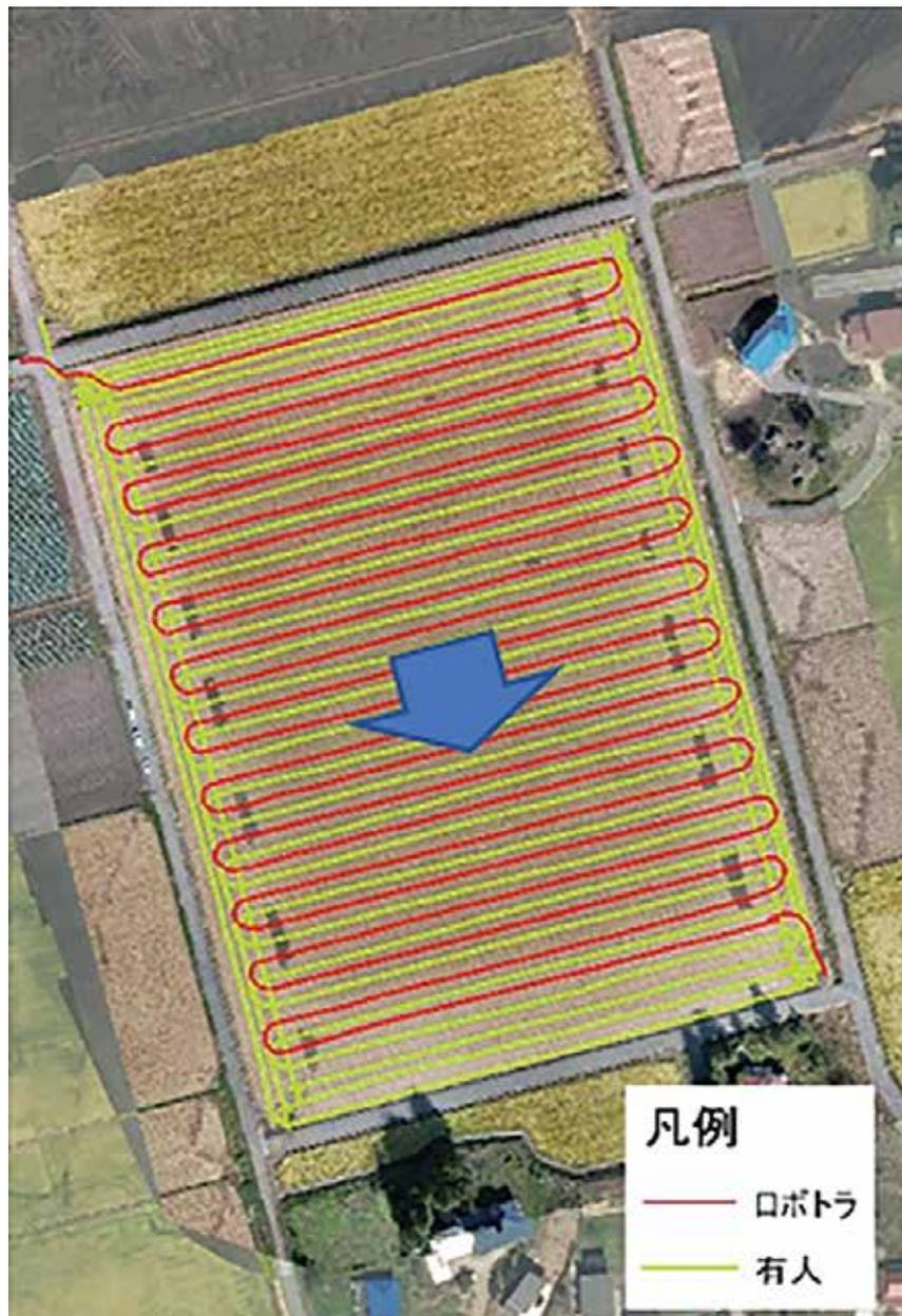
○上図は、スーパー大区画3.6haの代かき作業をロボットトラクター（無人）と有人トラクターの2台で協調作業した走行軌跡である。
