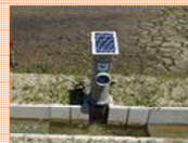
自動給水栓 (開水路用)
