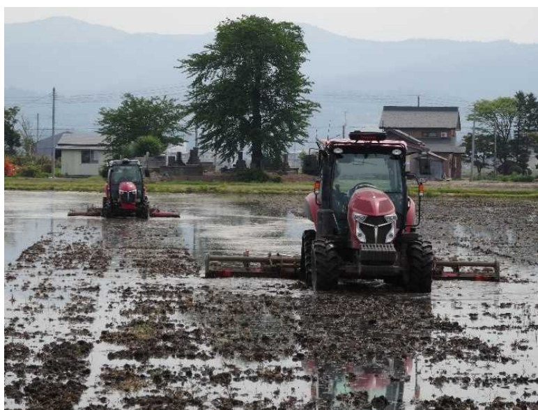
代掻き協調作業 （前方：無人口ボトラ、後方：有人トラクター）
