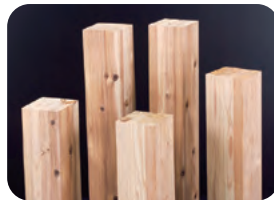
▲能代工場で製造する、スギを使った集成材
