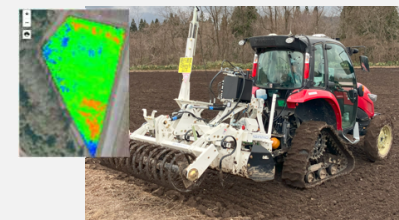
高低差マップを利用した高精度均平作業
