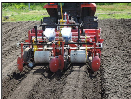
アップカットロータリによる 耕うん同時畝立て播種
