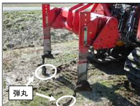
弾丸サブソイラによる補助暗渠
