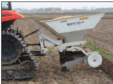
疎水材埋設機「モミサブロー」
