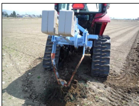
全層心土破碎機 「カットブレーカー」
