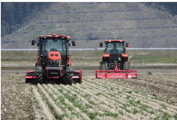
18 ロボットトラクタ、有人トラクタ同時作業
