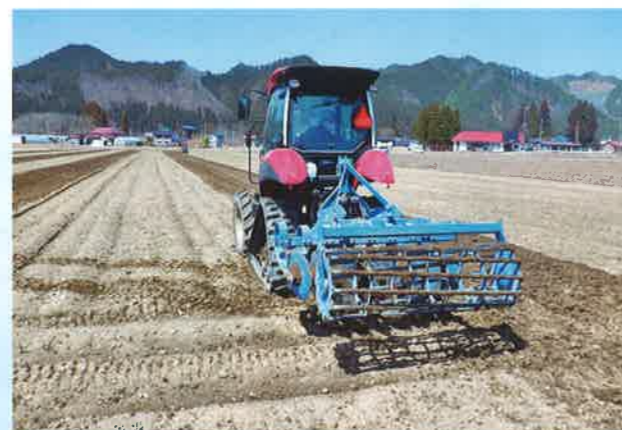
ディスクハローによる耕起試験
