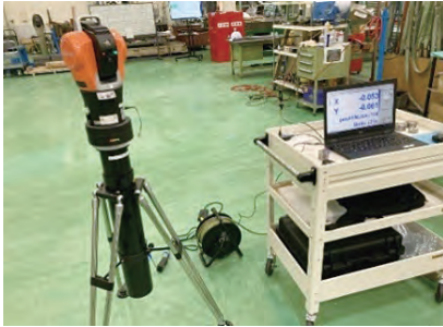
レーザートラッカー (φ80mの測定範囲)による測定を行い、全カ所の精度を保証
