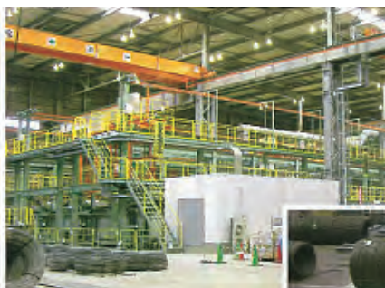
自動酸洗設備
