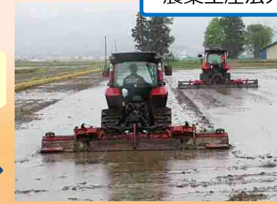
自動操舵装置搭載農機による代掻き・田植え作業
