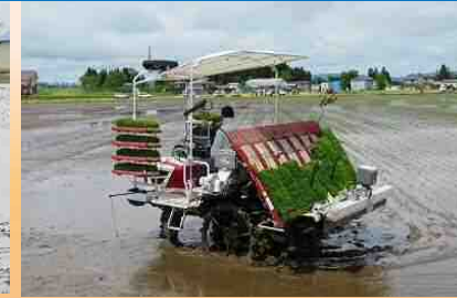
自動操舵装置搭載農機による代掻き・田植え作業
