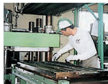
油圧プレス(600×1700) 長尺製品に対応
