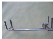
油圧系高圧パイプ
