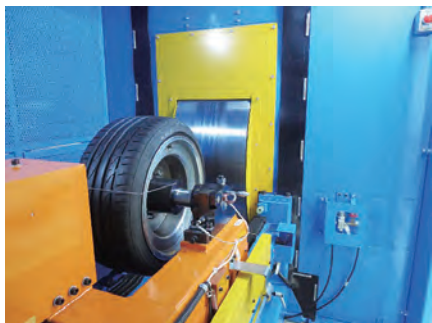
RFT+400km/h対応PSRドラム試験機
