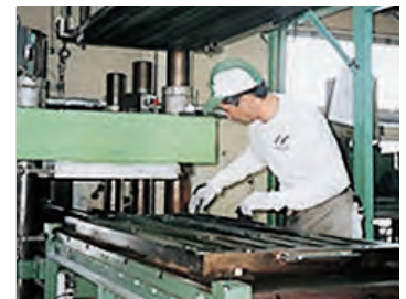
油圧プレス(600×1700) 長尺製品に対応
