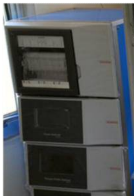
光化学オキシダント自動測定機 （本荘局）
