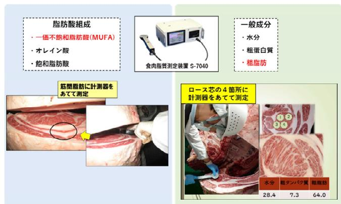
図2 食肉脂質測定装置での測定
