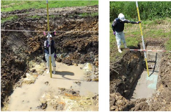
図2 岩盤の露出
