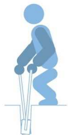
③ハンドルを操作しバケット先端を閉じ雪をつかみます。
