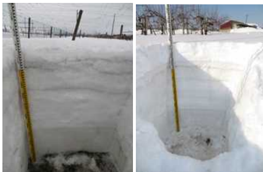
散布区 無散布区 図2 2月1日の積雪断面 (散布区は炭の層が明瞭)
