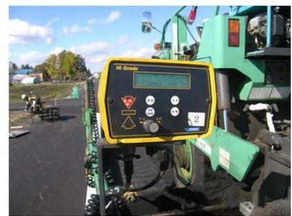
舗設機械への各種自動制御装置の
