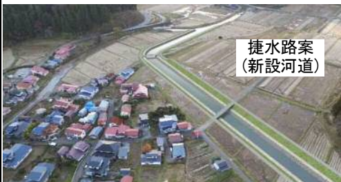
UAV空中写真を用いて捷水路案のフォトモンタージュを作成
