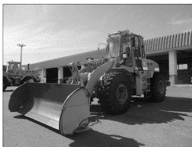
除雪ドーザ (18t級)
