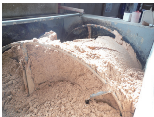
(攪拌機による培地調整)
