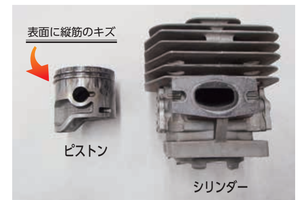
写真－3 エンジンの焼き付き（軽度）
