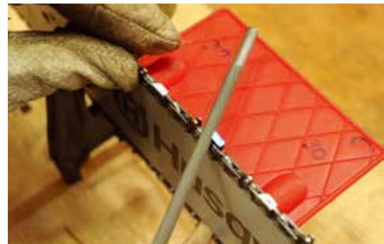
写真5 アングルプレートの使用
