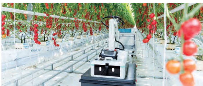
ミニトマト収穫ロボット技術で大玉・中玉トマトに挑戦((株)デンソー提供)
