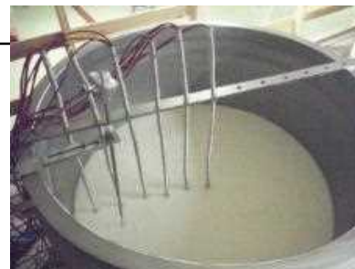
もろみ発酵の温度管理システム (発酵タンク内の常時温度監視を実現)
