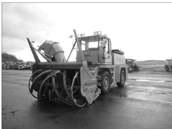
高速ロータリー除雪車（440kW級）
