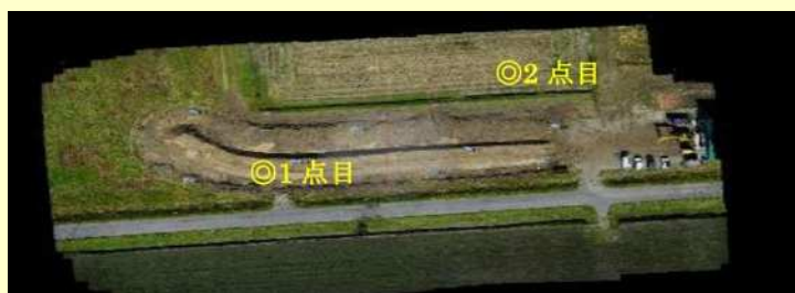
空中写真測量（UAV）で測定した検証点の位置座標
