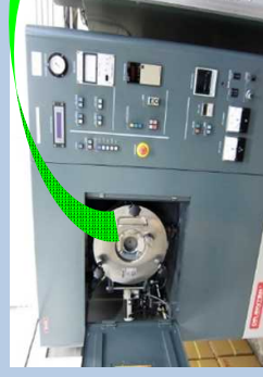
<通電加圧焼結>
