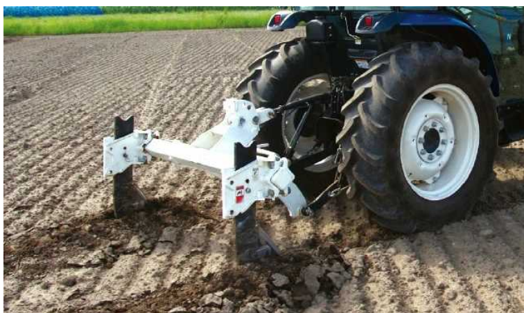
サブソイラーによる心土破碎
