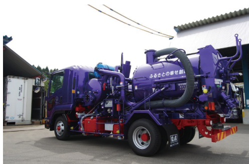
汚泥運搬車(強力吸引車) 超高圧水によるアスベスト除去工事で大活躍
