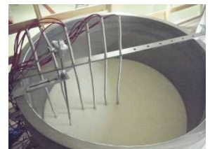
発酵タンク内温度分布の測定試験
