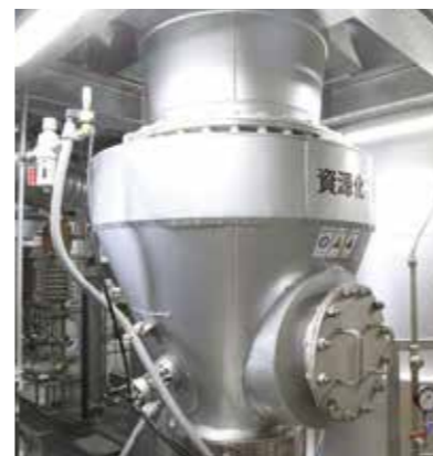
資源化物回収器 資源化物と熱分解ガスを遠心力により分離して、回収器の底部より資源化物を回収します。
