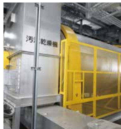
汚泥乾燥機 約500℃の熱風で水分20%となるまで汚泥を乾燥させます。
