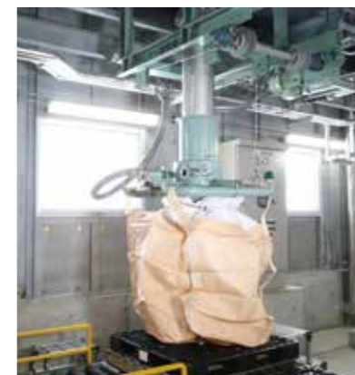
資源化物搬出設備 資源化物をフレキシブルコンテナに詰め、利活用先へ搬出します。
