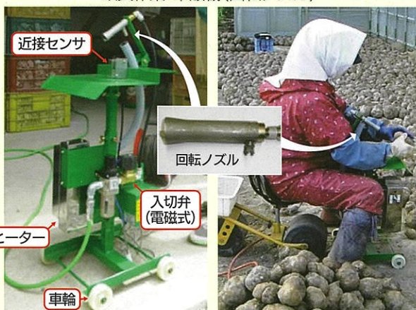
写真 作業状況の比較(左:慣行作業、中央:改良作業(市販機)) ※エアコンプレッサの吐出圧力は、0.4~0.6MPaである。
