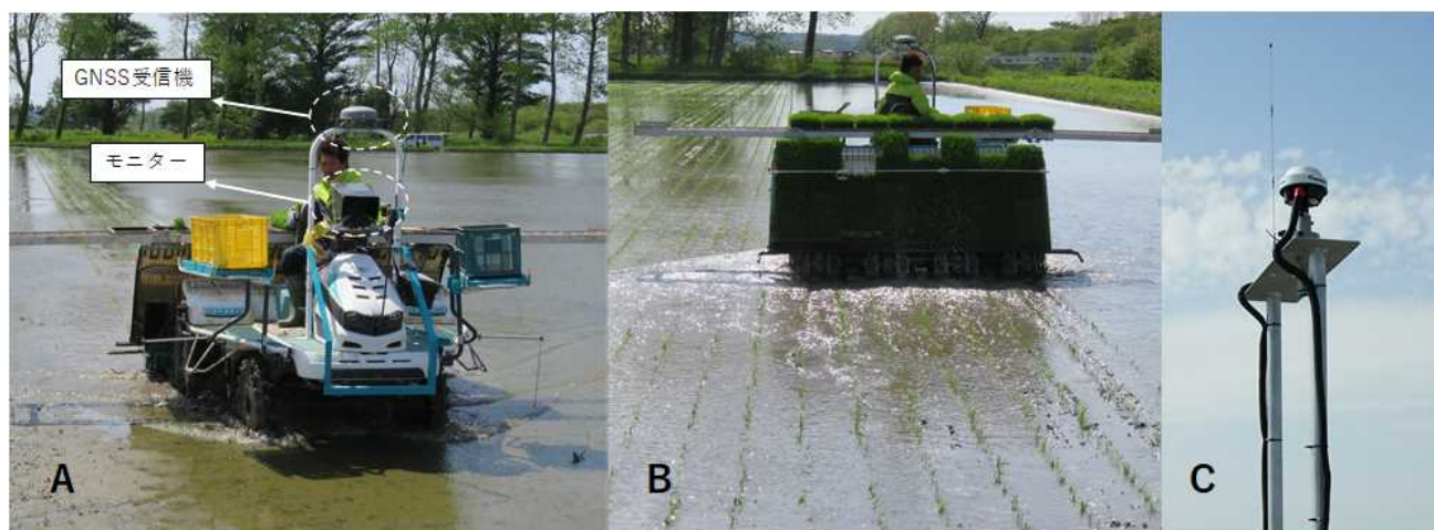
図1 GNSS自動操舵田植機による無落水移植の実施状況
