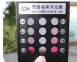
「残留塩素測定器」を用いた水質調査
