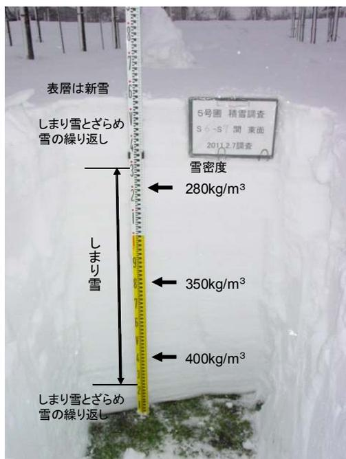
図4 積雪断面調査と密度(1m<sup>3</sup>の重さ)(果樹試2月7日)
