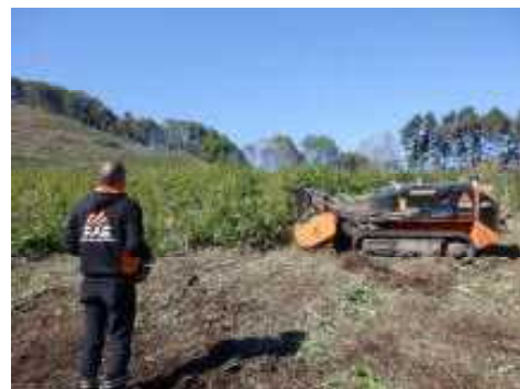
【スマート林業技術機械：ラジコン式下刈機械】
