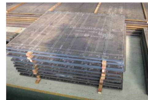
プラズマ切断機を導入し、製造・加工した建設用部材 [シー・アンド・シー(株)(小坂町)]
