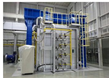
柱材の試験炉
