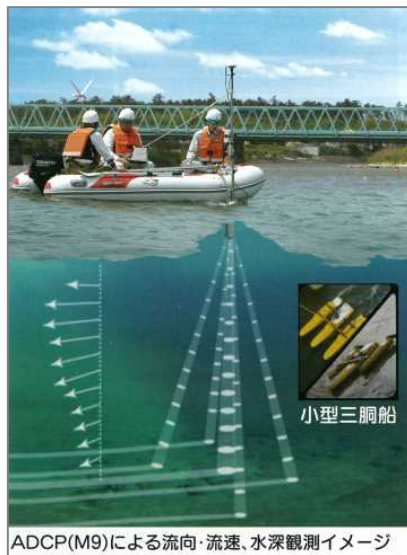
深淺測量(音響測深機)におけるADCP(M9)の活用
