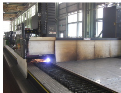
プラズマ切断機
